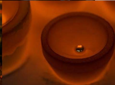
El Método de Ensayo al Fuego consiste en producir una fusión de la muestra usando reactivos y fundentes adecuados para obtener dos fases líquidas: una escoria constituida principalmente por silicatos complejos y una fase metálica constituida por plomo, el cual colecta los metales de interés (Au y Ag); que posteriormente serán sometidos a Análisis Químico o determinación gravimétrica, según condiciones finales de la muestra.
